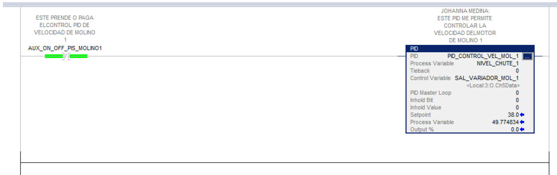
Figura 11. Rutina generada PID_ CONTROL_VEL_MOL_1
